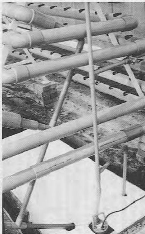
Fig. 6.18. A la derecha, líneas de alimentación desde la bomba, y, a la izquierda, las líneas de retorno al tanque acopladas a cada subunidad de 3 espiras de tubería.
