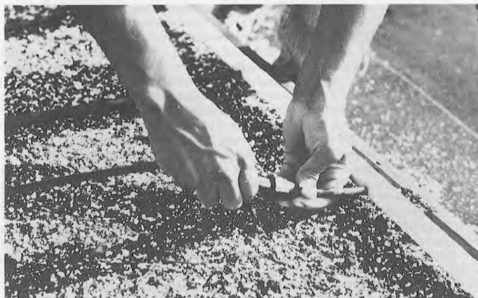
Fig. 8.18. Unión de una línea de goteo «T-tape» al adaptador de polietileno, que a su vez se une a la tubería de 3/4 de pulgada. (Cortesía de California Watercress Inc., Fillmore, California).
