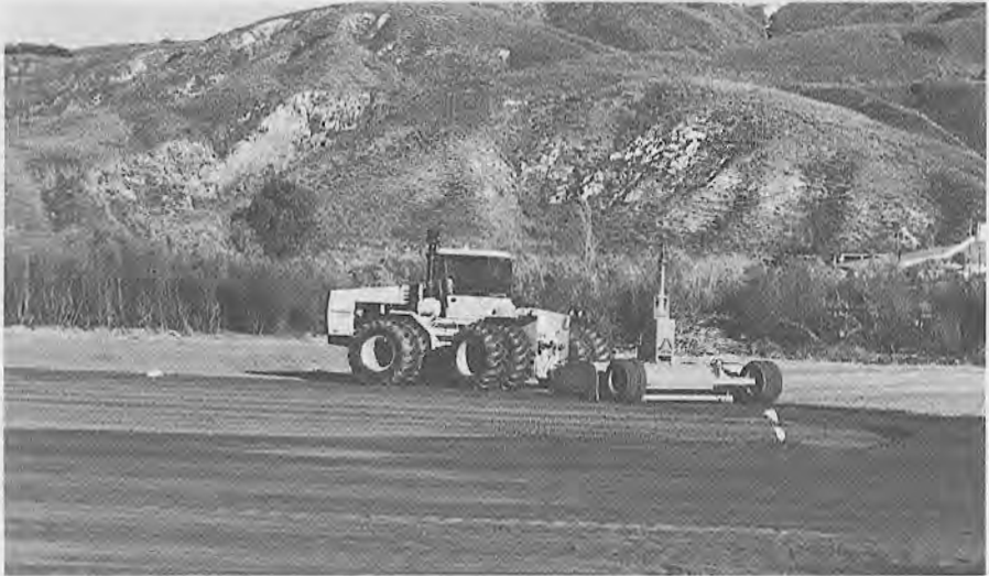
Fig. 6.65. Nivelación por láser de un campo de 3 acres. (Cortesía de California Watercress, Inc. Fillmore, CA).
