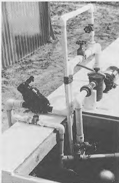
Fig. 6.89. Tanque de nutrientes con bomba de circulación, filtro a la izquierda y válvula flotante para llenado automático del tanque. (Cortesía de California Watercress Inc., Fillmore, California).
