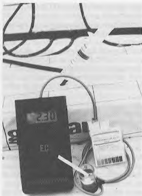
Fig. 10.23. Comprobación de la EC y del pH de la solución con un conductímetro y un papel para medir el pH. (Cortesía de Environmental Farms, Dundee, Florida).
