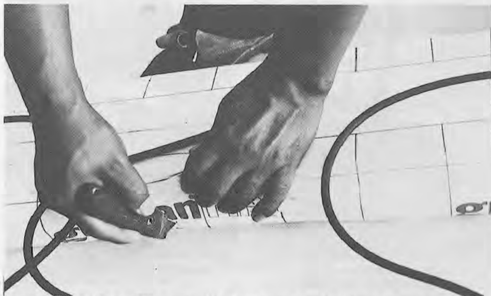
Fig. 10.16. Corte de los agujeros de drenaje en la parte inferior de las planchas. (Cortesía de Environmental Farms, Dundee, Florida).
